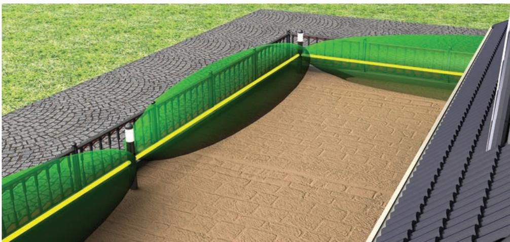
Perimeterschutz mit dem bistatischen Dualtechnologiesensor FORTEZA-FONAR-COMBI
