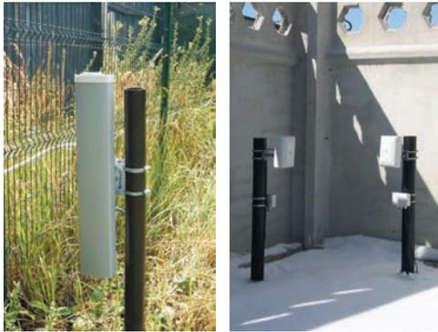
Das K-Frequenzband erhöht die Detektionswahrscheinlichkeit und minimiert externe Interferenzen. Die Frequenz von 24,15 GHz gewährleistet eine schmale Detektionszone, was die Sensoren gebräuchlicher macht. Außerdem man braucht keine spezielle Genehmigung, um diese Frequenz zu benutzen.
