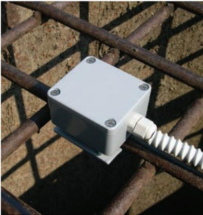
VIBRO ist zum Zauschutz gegen Zerstörungsversuche geeignet.
