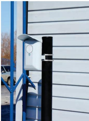
Das Erfassungsfeld wird mit einem Transceiver erzeugt, der aus Mikrowellen- und Infrarotkomponenten besteht.
